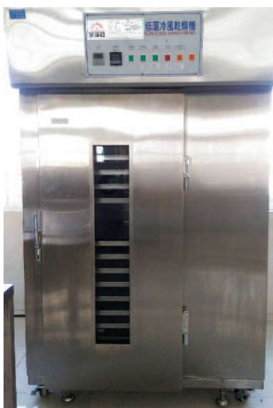
Hình 1. Máy sấy bơm nhiệt CYF-EL040
