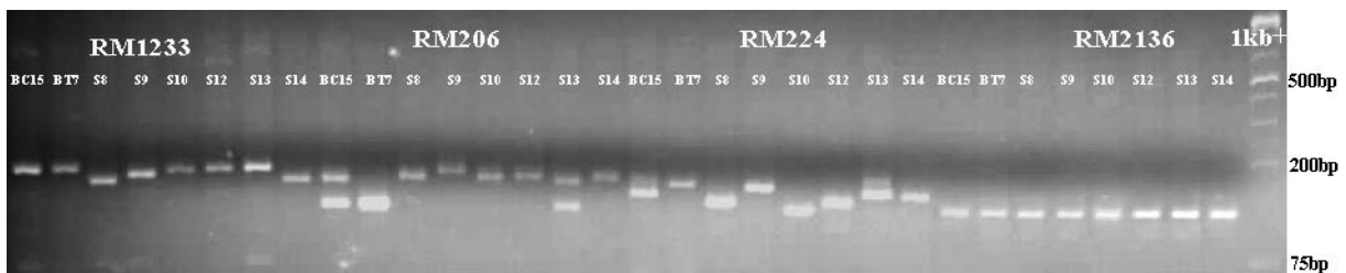
Hình 2. Kết quả khảo sát đa hình của các dòng/giống lúa với các chỉ thị RM1233, RM206, RM224, RM2136 trên gel agarose 2,5%
